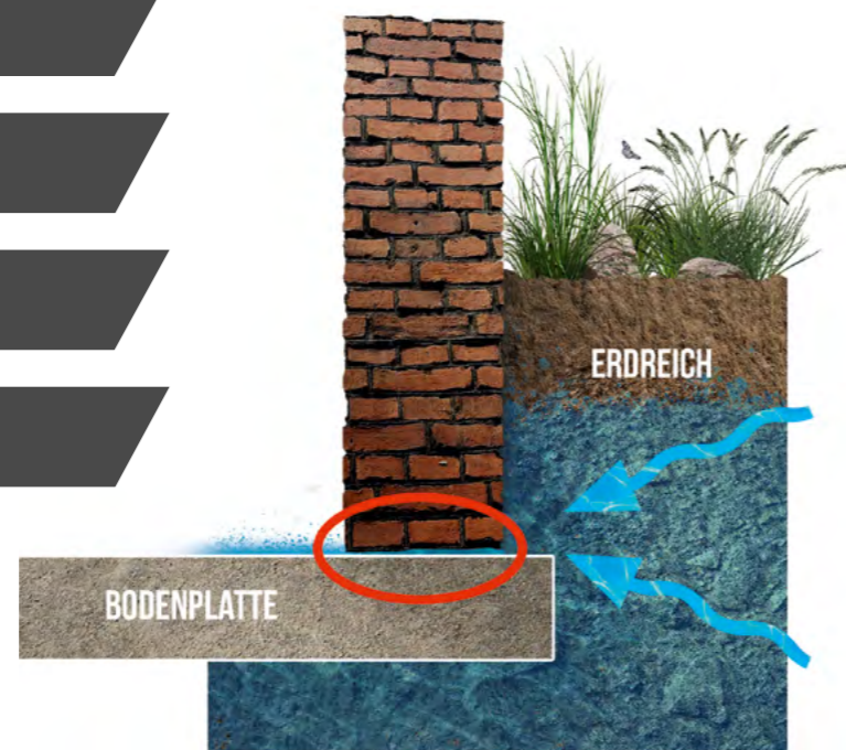
* Defekter bzw. undichter Boden-Wandanschluss
